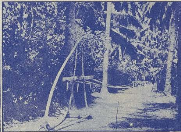
Filière pour la fabrication de la corde en fibre de coco
