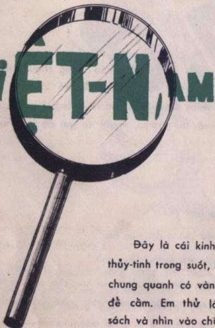
Đây là cái kính lúp. Kính lúp làm bằng thủy-tinh trong suốt, hình tròn, hai mặt lồi, chung quanh có vành giữ kính, dưới có cán để cầm. Em thử lấy kính này soi lên trang sách và nhìn vào chữ xem thấy thế nào?
