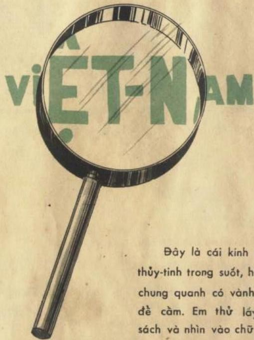
Đây là cái kính lúp. Kính lúp làm bằng thủy-tinh trong suốt, hình tròn, hai mặt lồi, chung quanh có vành giữ kính, dưới có cán để cầm. Em thử lấy kính này soi lên trang sách và nhìn vào chữ xem thấy thế nào?
